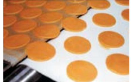
No final de ambos os processos, a correia segue para uma transferência tipo ponta de faca.
