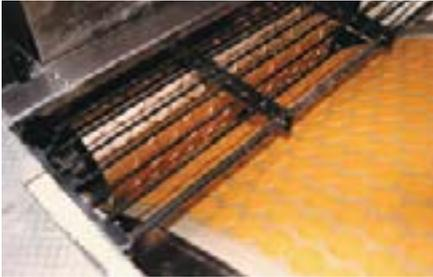
A massa é prensada em um tambor de moldagem rotativo que produz o formato dos biscoitos.
