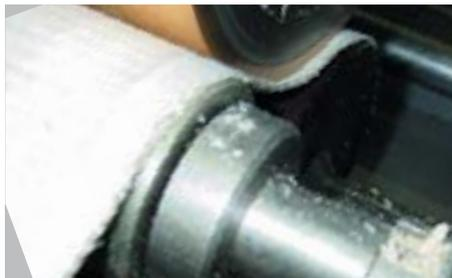
As correias AmDough são fabricadas de acordo com padrões de alta qualidade. A parte inferior é impregnada com PU resistente ao desgaste para manter o formato da correia e evitar desalinhamento. Cordões são usados para aumentar a resistência ao desgaste e poliamida para reforçar as orlas. Fios de linho fortes na trama garantem estabilidade lateral. Como resultado, por sua maior vida útil e capacidade contínua de absorção, as correias Tecidas Sem Fim AmDough são muito econômicas.
