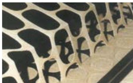
As correias Tecidas Sem Fim AmDough são adequadas para todos os tipos de massa de biscoito. Seus componentes são seguros e não transmitem cor, sabor nem cheiro aos biscoitos produzidos. A ausência de fibras antiestáticas significa que as correias podem ser usadas em combinação com detectores de metais.
