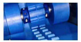
1) Através do design único do pinhão A roda central da roda dentada também suporta a estabilização e posicionamento. A correia é, assim, fixada na posição na unidade e na polia de retorno.
