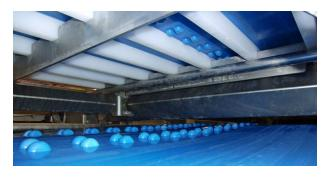
2) Através da utilização da esteira deslizante As tiras da esteira deslizante estão posicionadas de forma a atuarem como guias para as saliências de condução. Isso significa que a correia encaixase automaticamente ao longo de toda a esteira deslizante.
