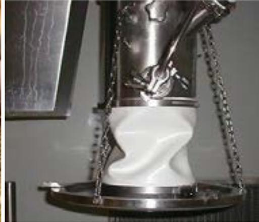
La souplesse et l'élasticité des manchettes AmPipe d'Ammeraal Beltech permettent de relier un tube fixe à une machine vibrante lors d'un transport par flux d'air. Les qualités exceptionnelles d'AmPipe offrent d'excellentes performances pour de nombreuses industries, de la pharmacie à l'alimentation, elles répondront aux normes les plus élevées, garantissant une longue durée de vie.
