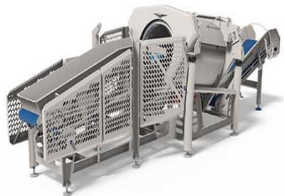
El túnel de secado por aire se ha desarrollado específicamente para secar las hojas delicadas de las verduras y para crear un porcentaje de humedad bajo. Asegura un flujo continuo del producto. La máquina puede secar rápidamente las hojas delicadas (ensaladas tiernas, albahaca, etc.) mediante aire deshumidificado, preservando la frescura del producto y aumentando la vida de almacenamiento.
