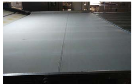
Banda sintética con cordón en espiral
