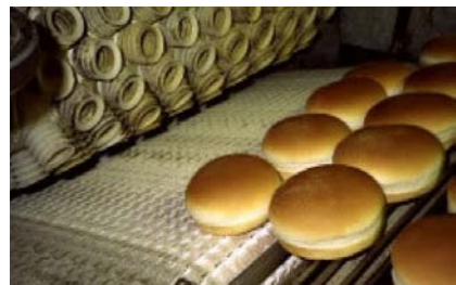
Sistemas desmoldeadores "on-line" basados en bandas con ventosas de succión.
