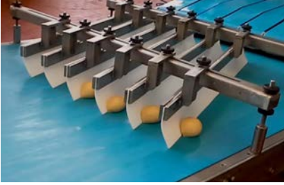
Banda azul en boleadora lineal con barra inclinada blanca
