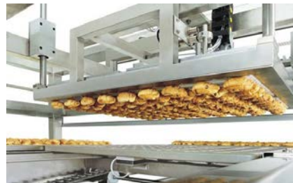
Sistema robótico de recogida y colocación
