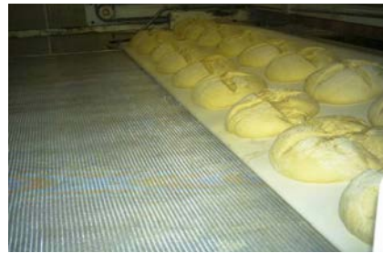
Banda de alimentador de horno de algodón sintética a la derecha y con banda de malla de acero a la izquierda.
