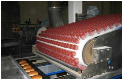
Sistemas desmoldeadores "on-line" basados en bandas con ventosas de succión.
