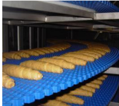
Fermentador en espiral con uni-ASB CS con masa de pan directamente sobre la superficie de la banda.
