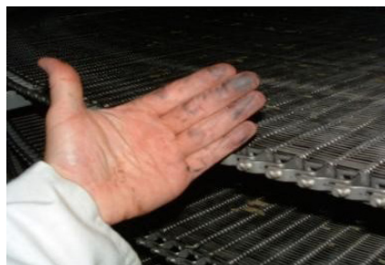
Problema de ennegrecimiento típico producido por el desgaste de la banda en espiral de acero.
