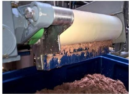
UltraScrapers an einem Band mit verschmutzter Motortrommel
