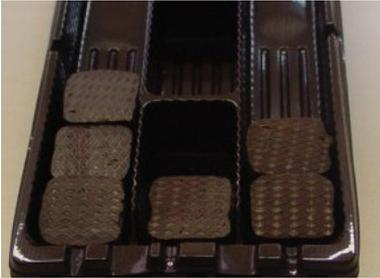
Unterseite von Pralinen bei falsch ausgerichteten Strukturen
