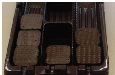
Cara inferior de chocolates con perfiles mal alineados.
