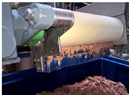
UltraScraper en marcha en banda con tambor de motor sucio.
