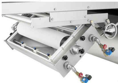
C.I.P. en el equipo del túnel de enfriamiento.
