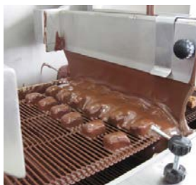
Recubrimiento de chocolate en banda de malla de alambre.
