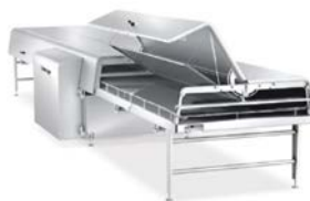
Túnel de enfriamiento con cubiertas
