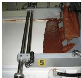
Se recomienda el uso de bandas blancas en la producción de chocolates marrones.
