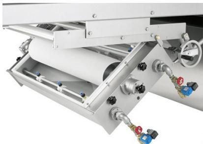
C.I.P. apparecchiatura di pulizia del tunnel di raffreddamento
