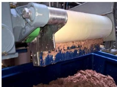
UltraScrapper operativo in un nastro con mototamburo sporco
