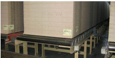
Pila de tableros típica en transportador de rodillos
