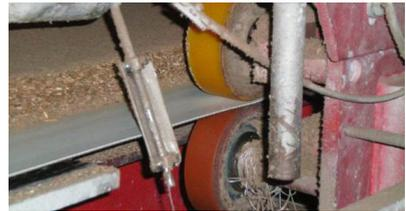
Las bandas de formación son centradas mediante dispositivos neumáticos.
