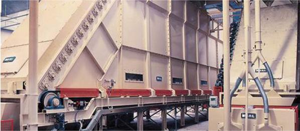
Búnker con banda de búnker y banda de pesaje
