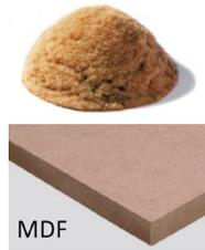
**¿Qué es un PB?** Los tableros de partículas (PB) se producen prácticamente del mismo modo que los MDF. Para ambos productos se usa la mismamadera y resinas. Sin embargo, las fibras de madera usadas en eltablero de partículas son más grandes que las de los MDF. Los tablerosde partículas poseen una densidad típica de 600-800 kg/m<sup>3</sup>.
