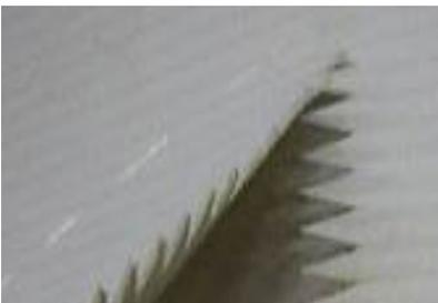
Fallo de empalme causado por el calor y un diámetro de polea pequeño.
