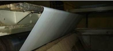
Banda de formación en un rodillo de 25 mm y en un arco de contacto de 135°.
