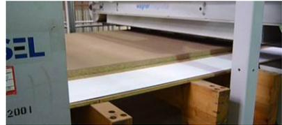
Lámina de fibra procedente del prensado
