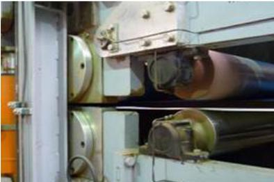
Rodillos presionando la lámina de fibra.
