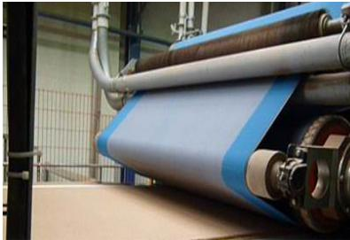
Lámina de fibra saliendo del pre-prensado. La contaminación estándar puede limpiarse con un cepillo y un aspirador.
