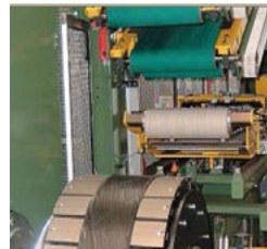
Servidores antes del tambor de construcción de neumáticos
