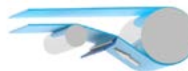
Posição do raspador após o eixo do motor. O raspador pode ser colocado na área superior e/ou na área inferior da correia
