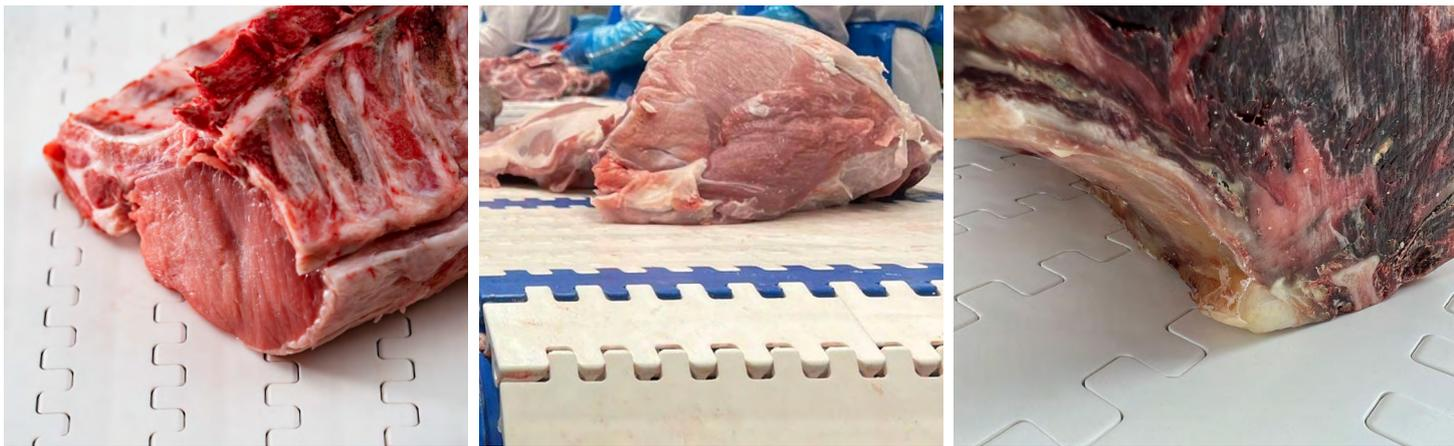
Dans les applications de découpes primaires de process de la viande rouge, la longue durée de vie et la facilité de nettoyage sont des propriétés clés des bandes transporteuses. Avec des décennies d'expérience dans l'industrie, Ammeraal Beltech a découvert une nouvelle solution innovante à ces défis : **l'uni DTB.**
