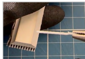
Den Stift langsam mit einer Zange herausziehen
