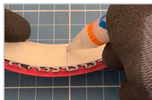
Die Rückseite des Riemens einkerben
