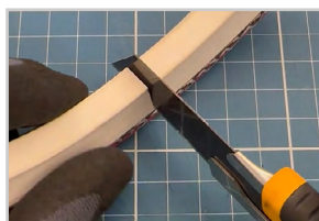
Den Keilriemen bis zum Gewebe einschneiden
