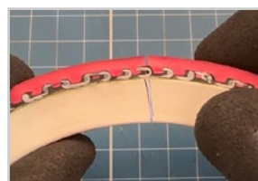
Encaje las espirales por presión manual
