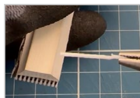
Tire el pasador hacia afuera con alicates
