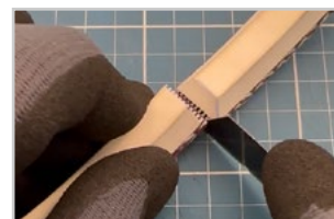
Corte la cobertura de la correa
