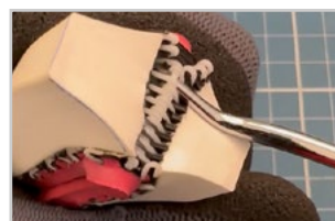
Haga palanca en el pasador usando un garfio
