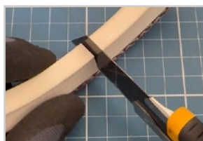
Corte la guía en V hasta la malla
