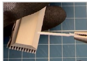
Sfilare lentamente il filo con le pinze
