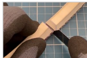
Tagliare con cura la copertura della cinghia
