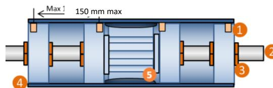
Il est toujours recommandé d'installer un profil de glissement pour soutenir le bord de la bande à une distance comprise entre 10 et 40 mm du bord de la bande.
