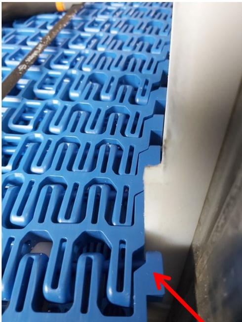
Punto de desacoplamiento de la banda de la barra de la jaula
